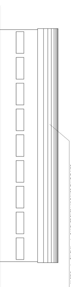
COPERTURA IN LASTRE CURVE DI CEMENTO AMIANTO DA SOSTITUIRE
