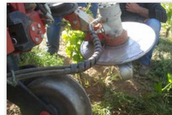
Foto 2: Organo lavorante della fresa con asse di rotazione verticale impiegabile su sottofila.
