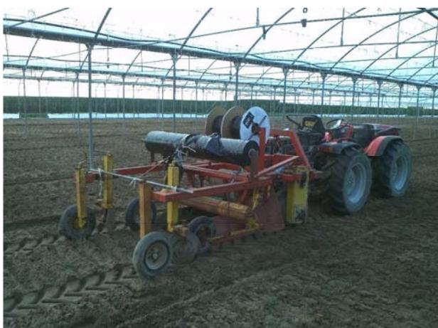
Foto 5 – attrezzatura per la baulatura e la stesura del telo
